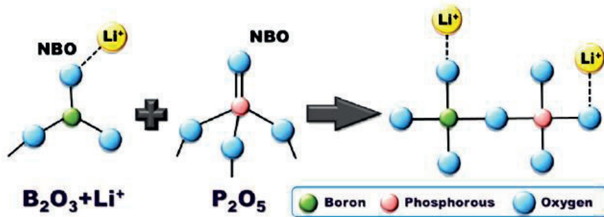
Obr. 4.44 Tvorba nemostíkového kyslíka so zmiešaným účinkom v systéme borofosfátového skla s Li [93]
